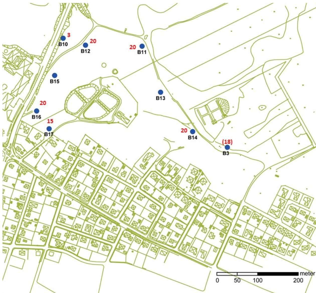
Fig. 5. Karta över uttagsbrunnarna på Galgbackens vattenanläggning med utsatta uppehållstider i dygn (röda siffror) tolkade utifrån genombrottskurvor (modifierad efter Hässleholms Vatten AB, 2014).
