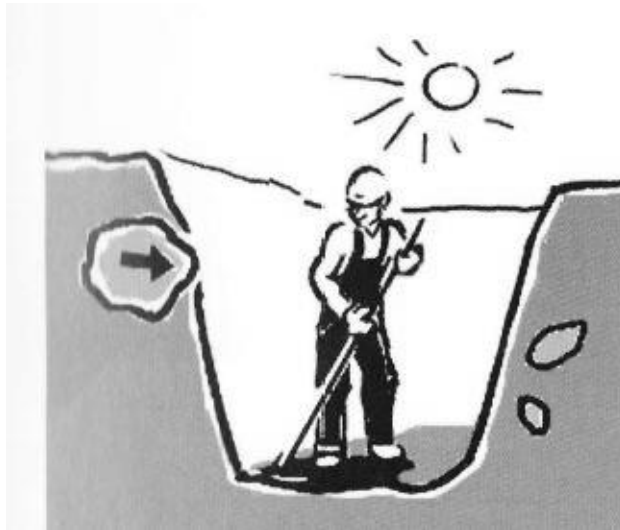
Figur 8. Tjällossning (Arbetsmiljöverket/ Statens geotekniska institut, 2003). Risk för stenar och block som faller ner då tjälen tinar
