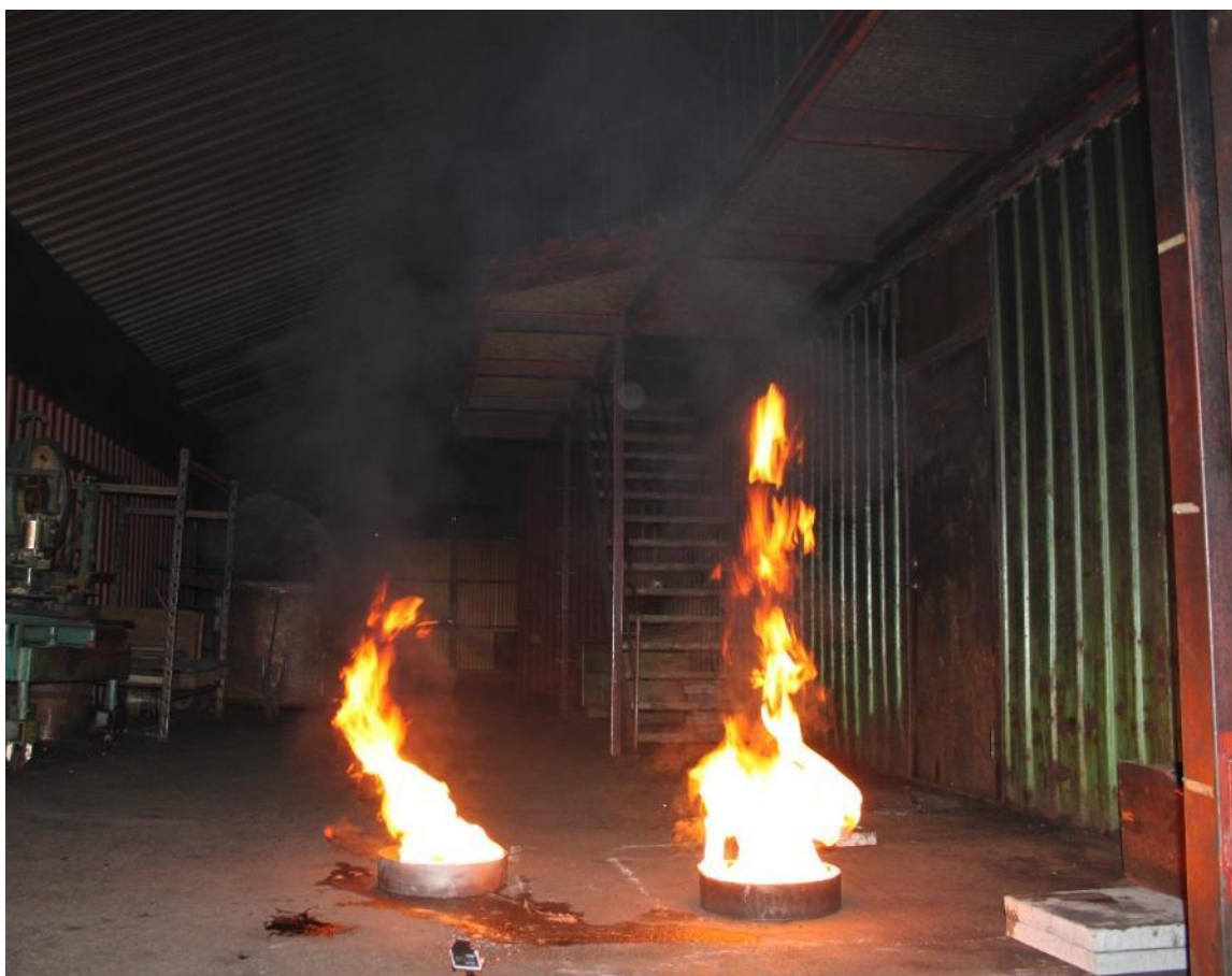
Figur 53 - Försök med tvåtaktsolja till vänster och heptan till höger.
