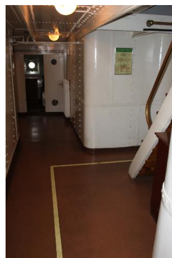
Figur 45 - Markering längs golvet som leder till utrymningsväg. Trappan till höger är upp mot kabyssen.
