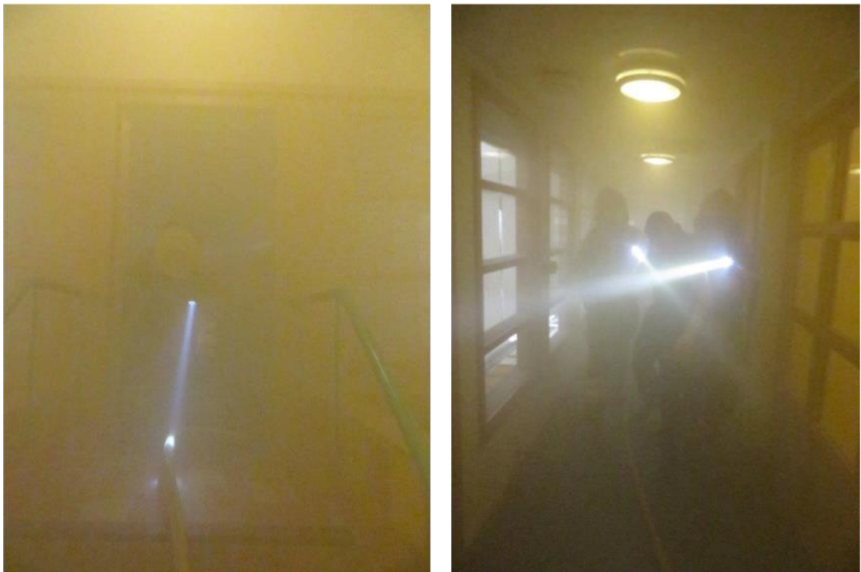
Figur 47. Bilder från utrymningsförsöket med kallrök. Till vänster: Dörren in till studiekorridoren sett från trapphuset. Till höger: studiekorridoren (Lindergren, 2015).
