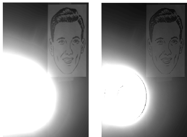
Före (vänster) och efter (höger) strörljuskompensationen.
