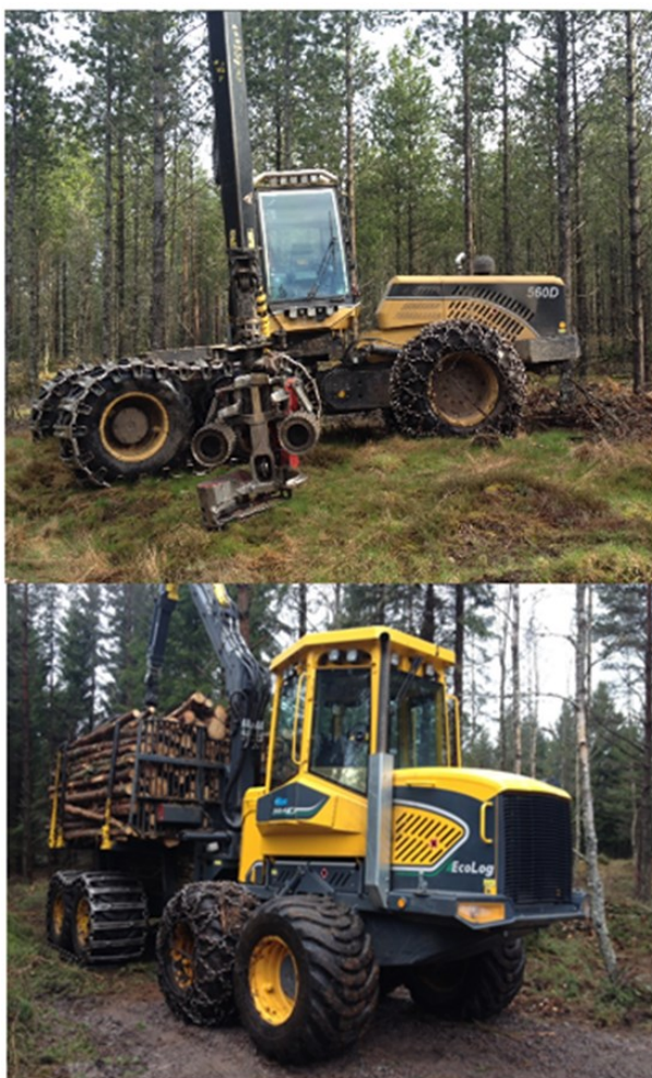
Fig. 1. Övre bilden visar en skördare och den undre bilden en fullastad skotare. Båda maskinerna används enbart för gallring. Foton: Jan Holm
