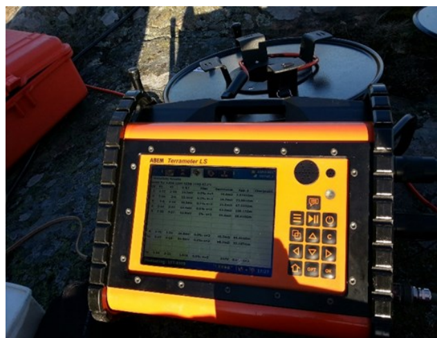
Figur 7. Bild på en ABEM Terrameter LS. Bilden är tagen under tiden som mätningar pågår. Bild tagen av Erik Fennvik
