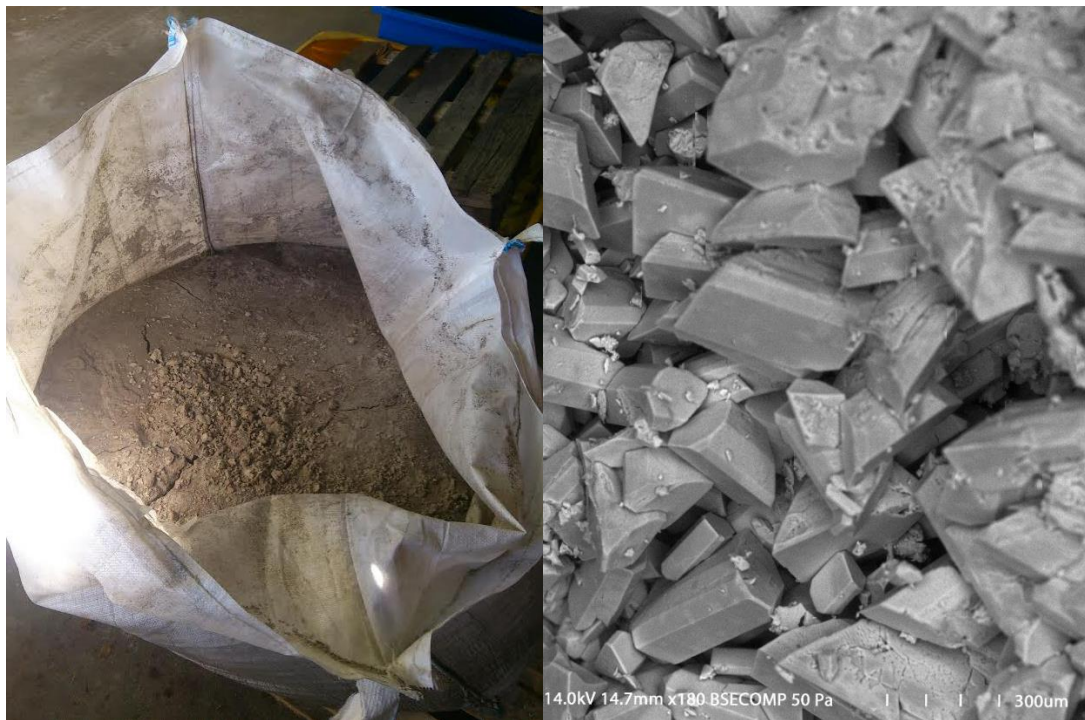
Figur 8: En säck med blöt struvit och en svepelektronmikroskopbild av struvit, tillverkat av Ekobalans, från pilotförsöksanläggningen vid Öresundsverket i Helsingborg (2012).
