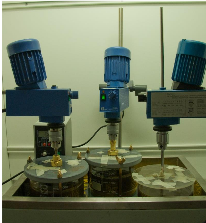
Figur 9: Uppställning av fosforsläppsförsöket (högra reaktorn) samt de två reaktorerna för hydrolysförsök på bioslam från Öresundsverket (vänstra reaktorn och mittenreaktorn, (9-16 mars 2015).
