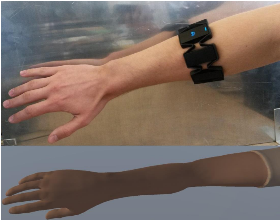
Figur 24 Den övre bilden visar den verkliga armens position och den undre bilden visar simuleringen då endast Myo:n används för att styra simuleringen.
