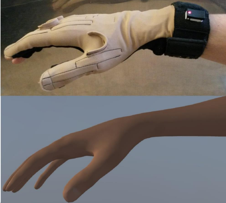
Figur 26: Den övre bilden visar den verkliga handens position och den undre bilden visar simuleringen då endast CyberGlove:n används för att styra simuleringen.
