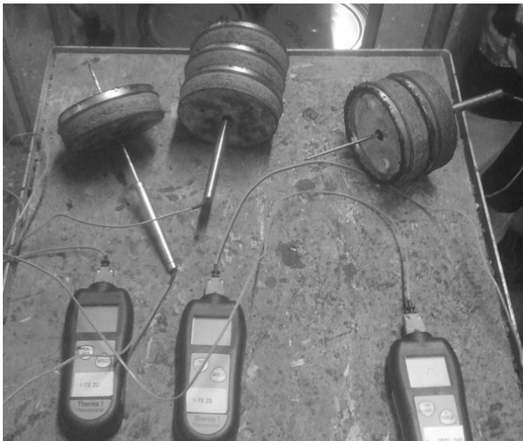
Figur 22 Preparerade termometrar med korklock som distanser för att mäta temperatur på olika djup i asfaltmassan.
