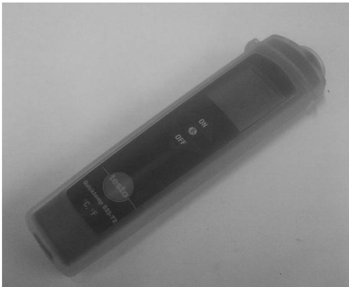
Figur 24 IR-mätaren som användes för temperaturloggning under blandning.
