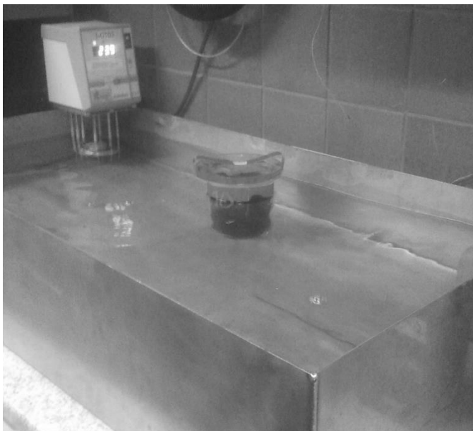
Figur 20 Pyknometer behållaren i vattenbad inställt på 25°C.
