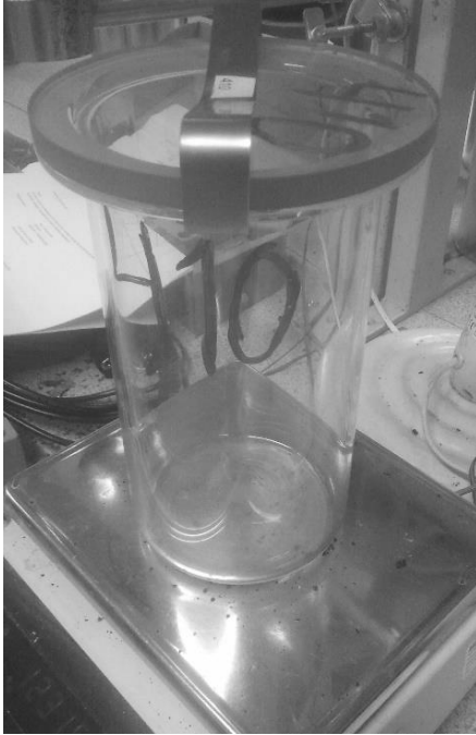
Figur 18 Pycnometerbehållare med markering för kalibreringen vid 25°C.
