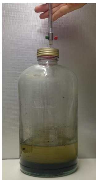
Figur 3.2. Bilden visar en tvålitersflaska med ymp, substrat och vatten. Ett gasprov togs ut ur flaskan med en trycktät spruta som sedan analyserades i GC:n
