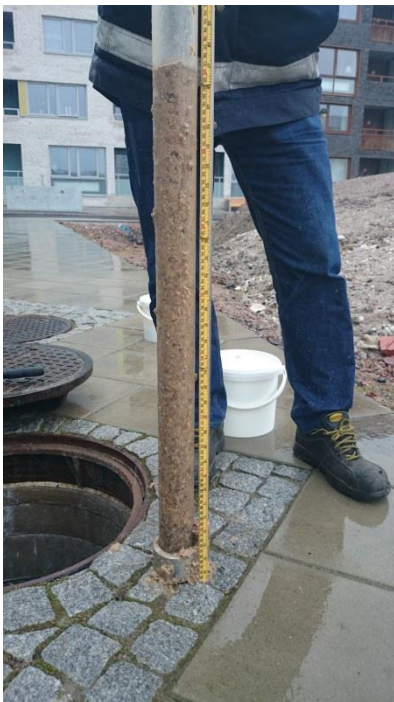
Figur 3.1. Wincklerröret fyllt med matavfall under en provtagning.
