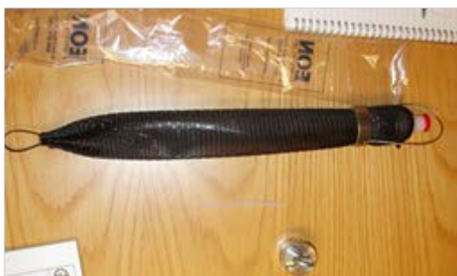
Figur 19: Bild på den passiva provtagaren. Provtagaren är ungefär 60 cm lång, ca 3 cm i diameter och innehåller 220-350 ml avjoniserat vatten.
