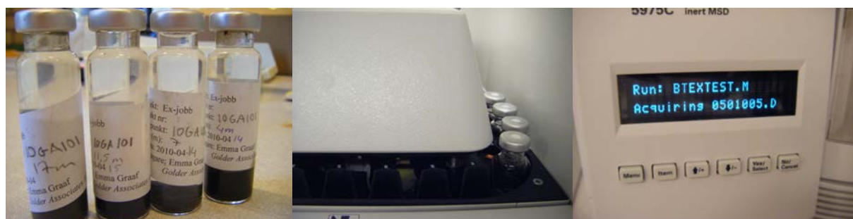
Figur 24: Analyser av grundvattenprover från fältundersökningen med metoden GC/MS-headspace teknik på ALS Scandinavia. Från vänster: vialer med grundvattenprover, vialer installerade för analys i GC/MS-apparaten, BTEX-program används för headspace-analysen.
