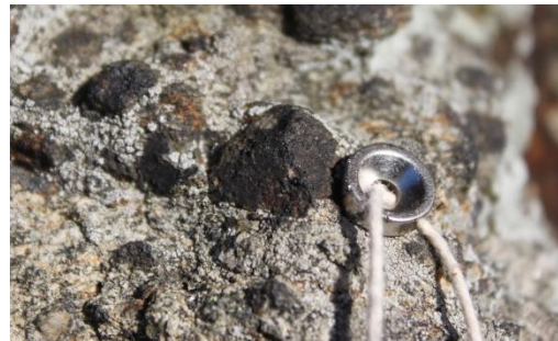
Fig. 1. Magnetit är ett av flera olika mineral som innehåller järn och titan. Just magnetit kan man lätt identifiera eftersom det är magnetiskt.
