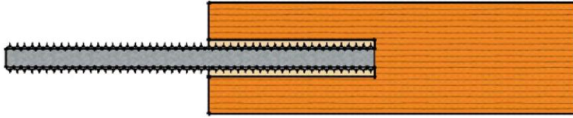
Figur 2.19 – Metod med förutbestämd limmängd utan kontrollhål
