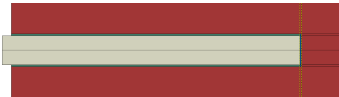
Figur 3.20 - Genomskäring. Beige är skruven, grönt är limmet, blått är luftglappet vid skruvänden och rött avser limträet.
