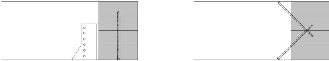
Figur 2.37 – Förstärkning med hjälp av skruvar. Efter (Trautz, 2009)
