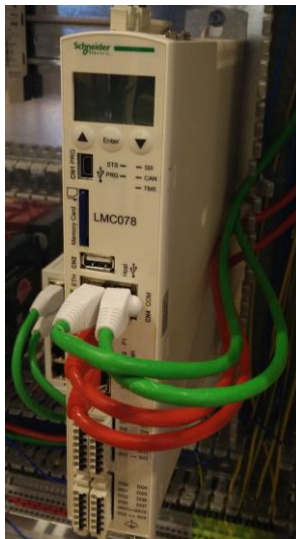
Figur 3.2 Illustrerar styrenheten LMC078
