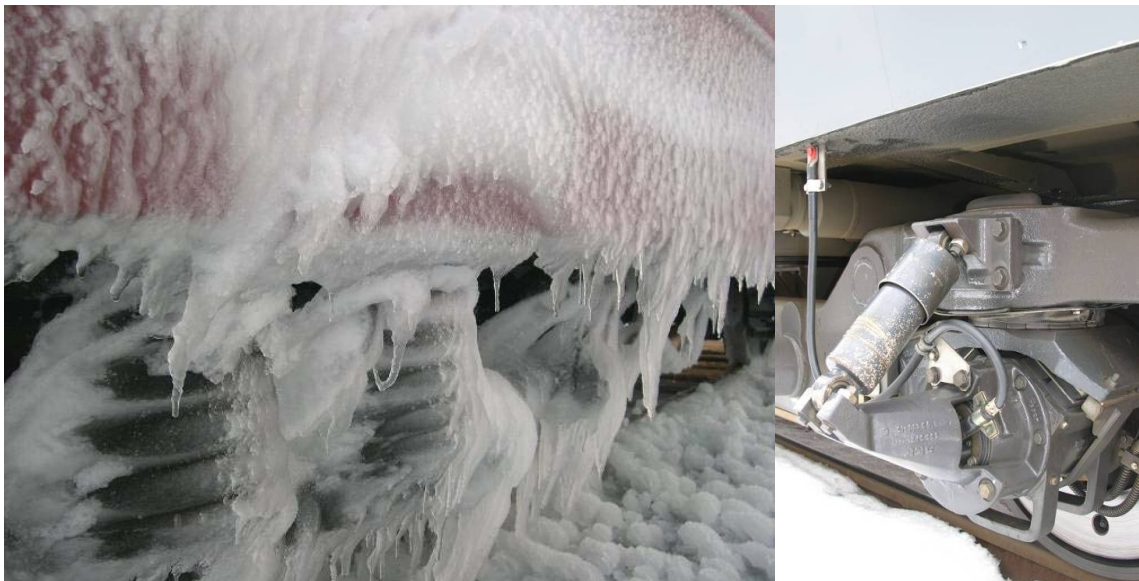
Figur 11 Till vänster istäckt boggi - Till höger ser man tydliga hålrum vid dämpare/fjädrar (Kloow 2011).
