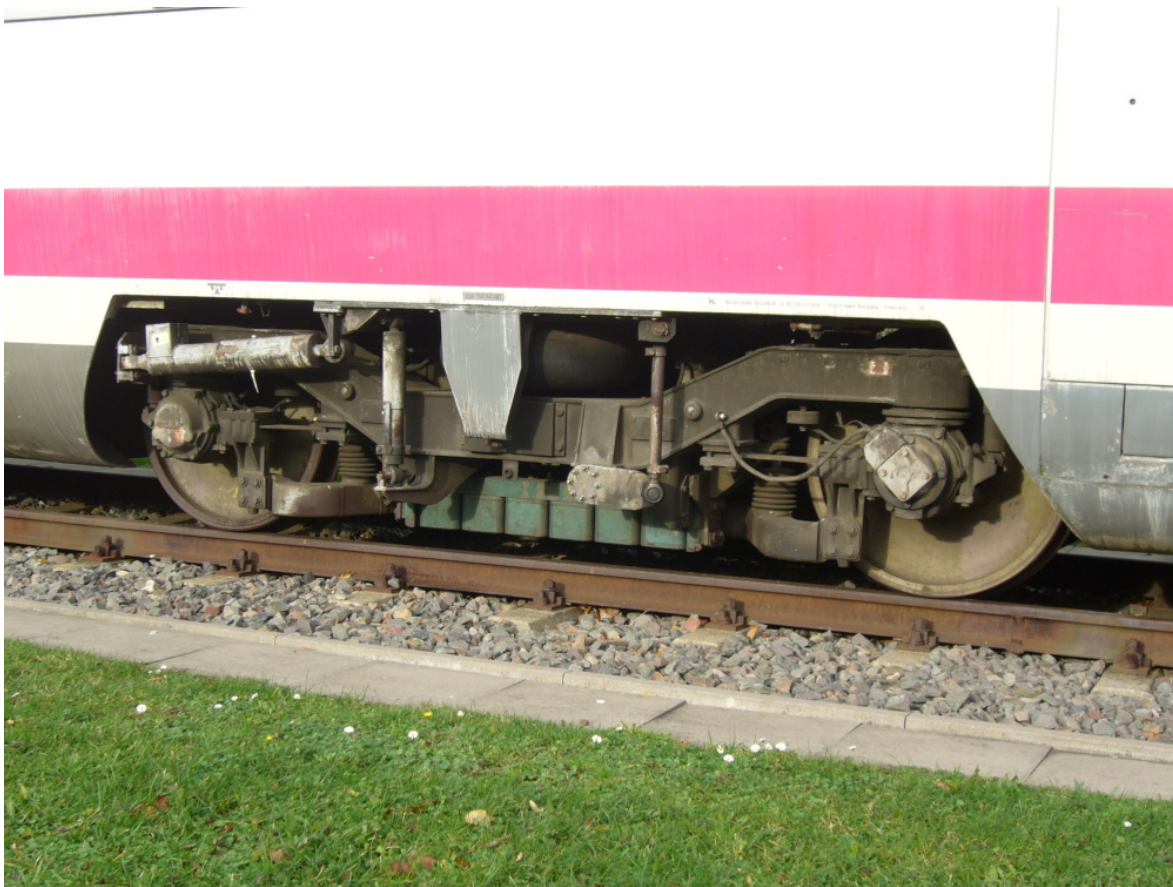
Figur 8 Boggi på ett tyskt ICE-tåg (Bigbug21 u.å.).
