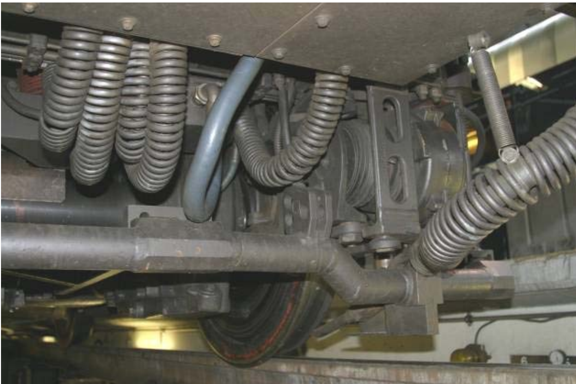
Figur 14 Kablar med skydd på ett norskt tåg (Kloow 2011).
