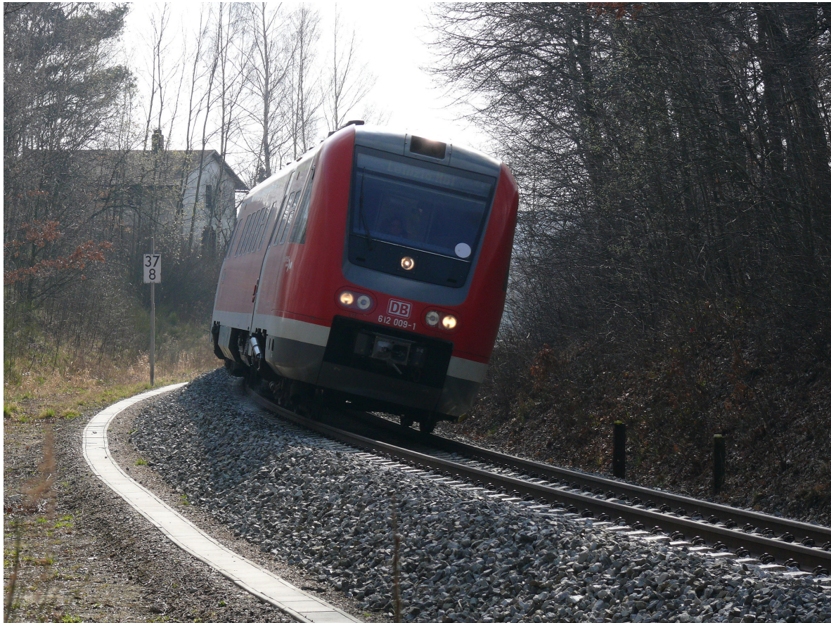
Figur 9 Tyskt tåg – Här syns både vagnskorgen (karossen) och korglutning (Gutwin u.å.).
