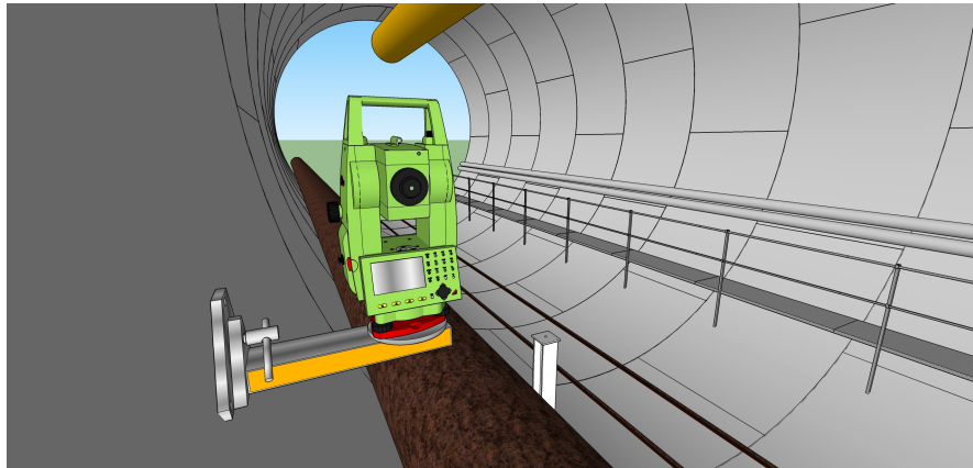
Figur 15 – Platta med Unikonsol och totalstation
