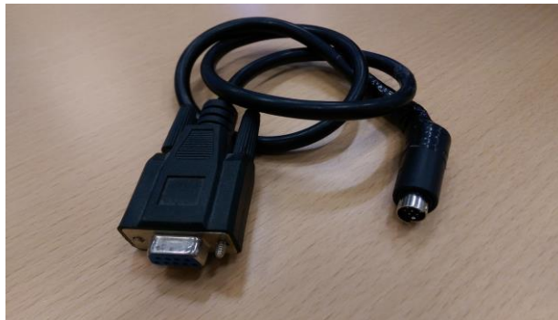
Figur 23 – Det färdiga resultatet av Mini DIN -> D-sub
