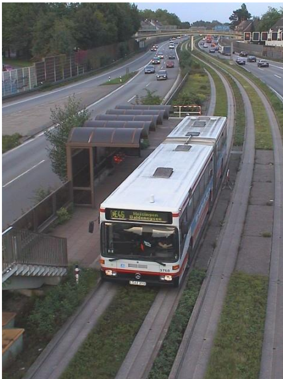
Figur 2-5 O-bahn mellan motorvägens körbanor (just denna bana saknar kontaktledning). Bild: JuergenG (2000) "Spurbus Essen1". Licenserad under CC BY-SA 3.0 via Wikimedia Commons
