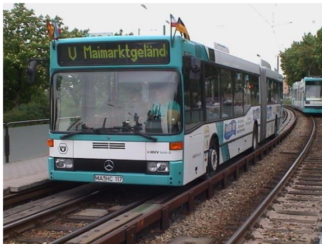
Figur 3-8 Spårbuss i Mannheim samkörd med spårväg. Bild: LennartBolks (2005) „Spurbus Mannheim I“. Licensierad under CC BY-SA 3.0 via Wikimedia Commons
