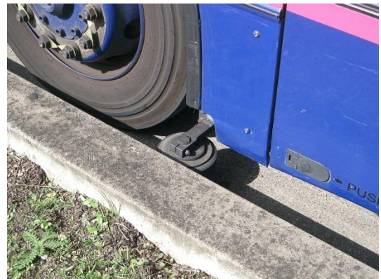
Figur 3-9 Styrhjul vrids in hjulaxeln i rätt läge. Bild: Spsmiler (2014a) "Ipswich-UK-guided-busway2". Licensierad under Public Domain via Wikimedia Commons
