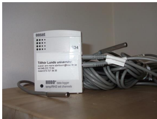
Figur 14 - Den vanliga (interna) loggern med externa mätare.
