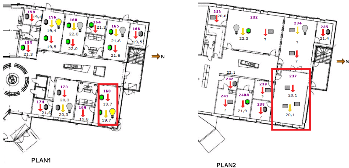
Figur 16. Lufttemperaturmätningar har genomförts i rum 168 och 237.
