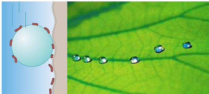
Figur 21: T.V Lotusans smutsavvisande förmåga. T.H Lotusbladens hydrofoba yta. Källa: Sto Lotusan färg, 2014.
