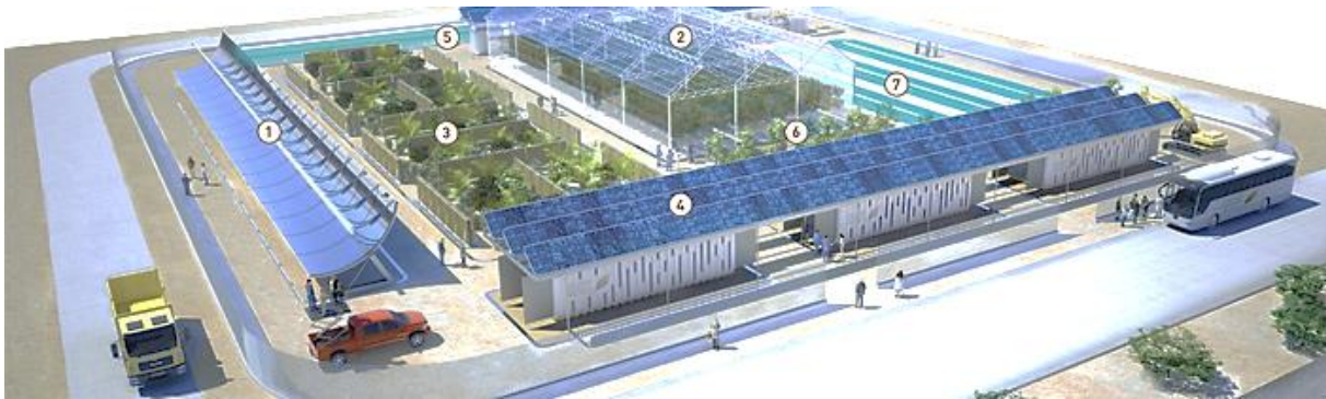
Figur 28: En överblick på pilotanläggningen i Qatar. 1. Termiska solkraftverk. 2. Saltvattenväxthus. 3. Vegetation och avdunstningsanordningar. 4. Solceller. 5. Saltvattenproduktion. 6. Halofyter. 7. Algproduktion. Källa: Sahara Forest Project, 2012.
