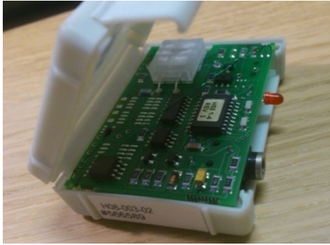
Bild 3.4.3:1 Närbild på HOBO logger från Onset
