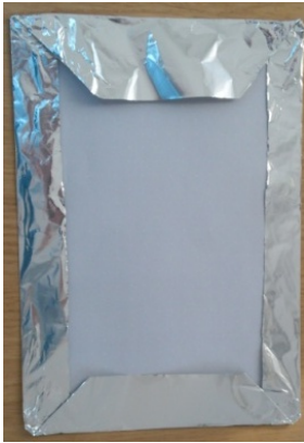
Bild 3.4:2:1 Solskydd av aluminiumklädda papper
