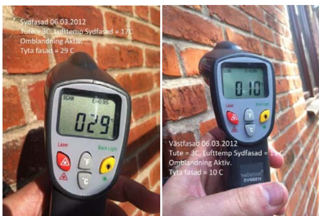
Bild 7:2 Höger bild visar temperatur på västfasad, vänster bild visar temperatur på söderfasad.
