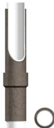
Figur 6 Relining av avloppsstammar
