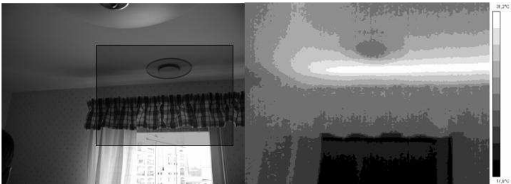
Bild 3: Värmenivåer vid punkt 1, tak, sovrum. Värmespår kan observeras i bjälklaget fram till vänstra kanten av fönstret där den viker in ca 45 grader mot lägenhetens centrum. Värmeskalan sträcker sig mellan ca 18 - 31°C.
