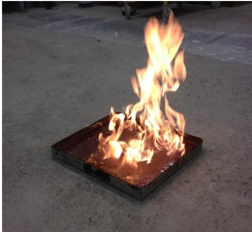
Figur 7- Eldning av ett representativt sandprov för att bestämma fuktkvoten i sanden.
