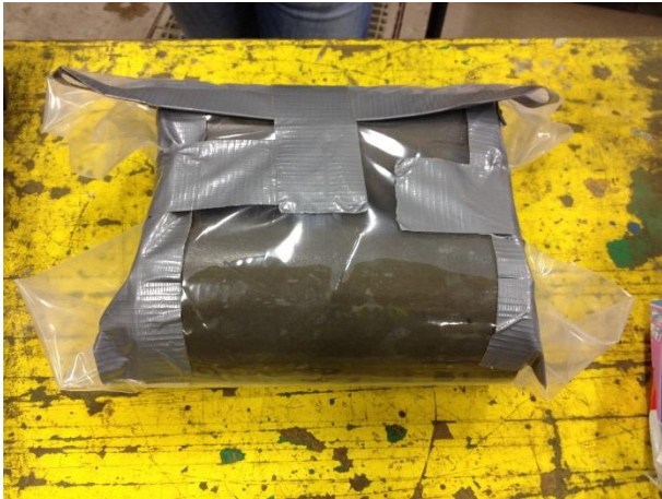
Figur 10- Efter ett dygn i cylinderformarna lades proven i plastpåsar och förslöts mycket tätt. Detta för att förhindra uttorkning.
