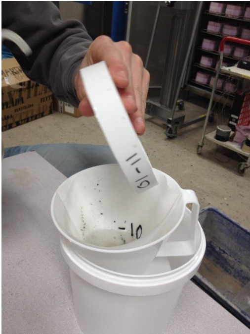
Figur 17- Avskalningarna i plastburken sköljs ner för silning genom ett kaffefilter.
