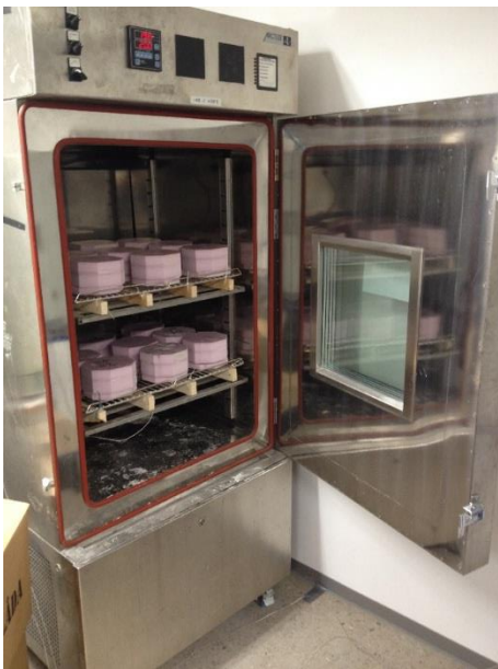
Figur 15- En av de fyra olika frysarna, med totalt 18 prover i frysen, 9 prover på varje hylla.
