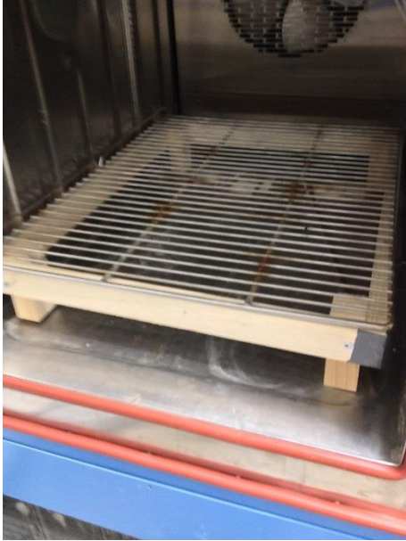
Figur 14- Anordning att ställa proverna på. För att säkerställa god luftcirkulation i frysen höjs gallernivån med 10 cm ovan kylens botten.
