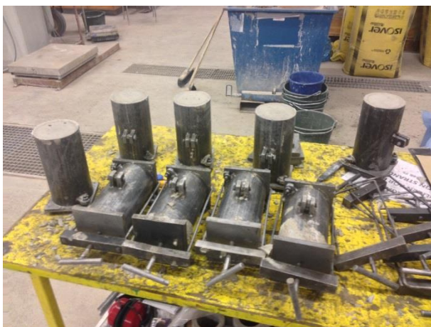
Figur 9- Cylinderformarna där den fräska betongen hälldes i och härdade i ett dygn.
