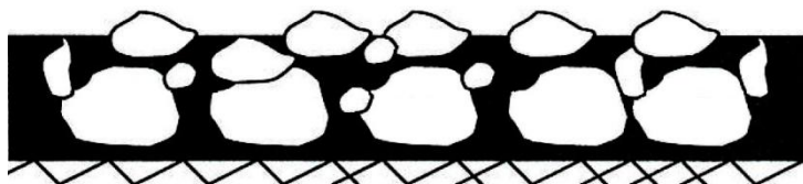
Figur 44: Principbild på en dubbel ytbehandling (Agardh & Parhamifar, 2014).
