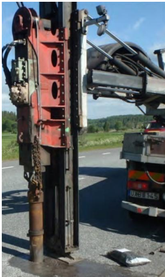
Figur 21: Provtagning med typen tryckrör (Trafikverket, 2012b)
