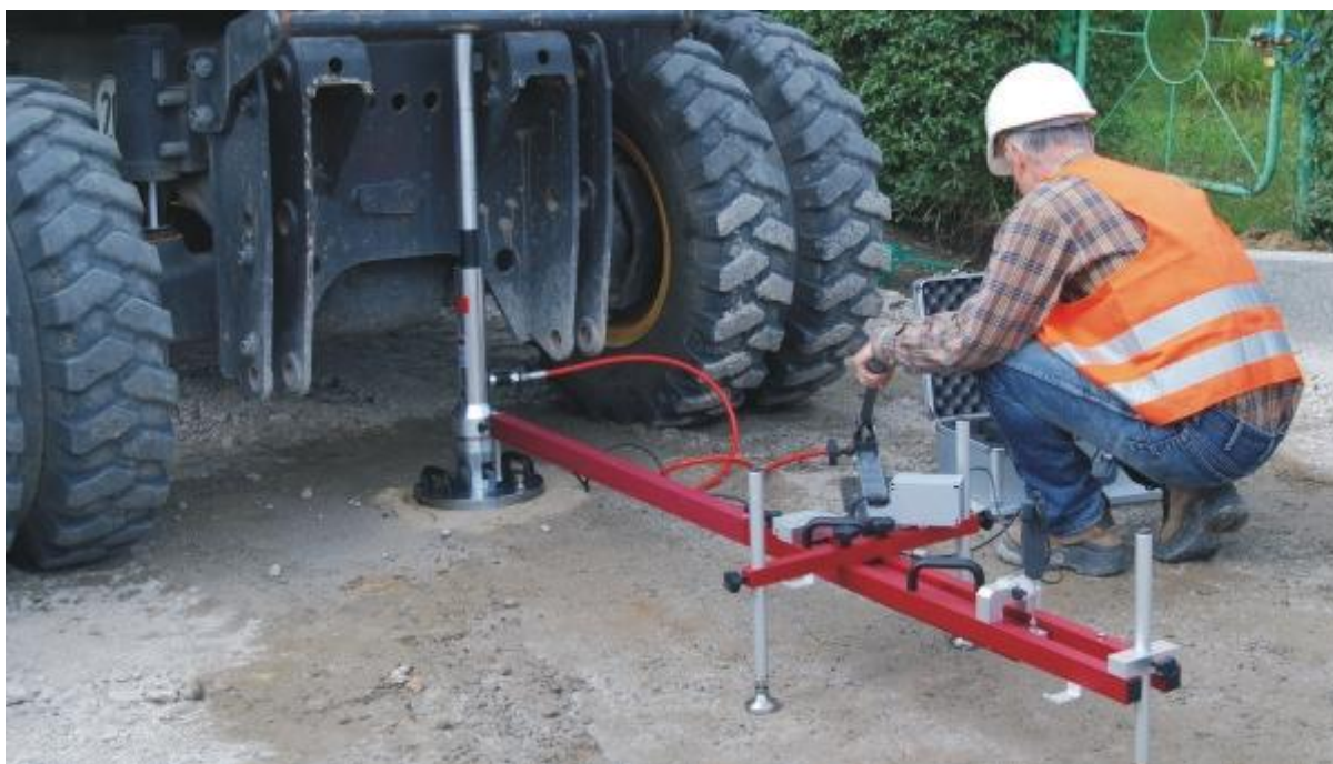
Figur 14: Bild på en statisk plattbelastare (HMP, 2015)
