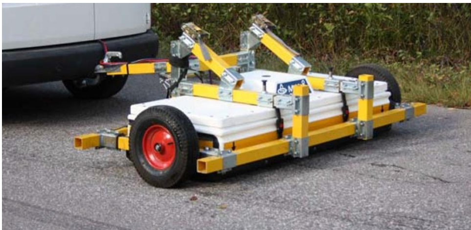
Figur 25: En modell av georadar (Trafikverket, 2014c)
