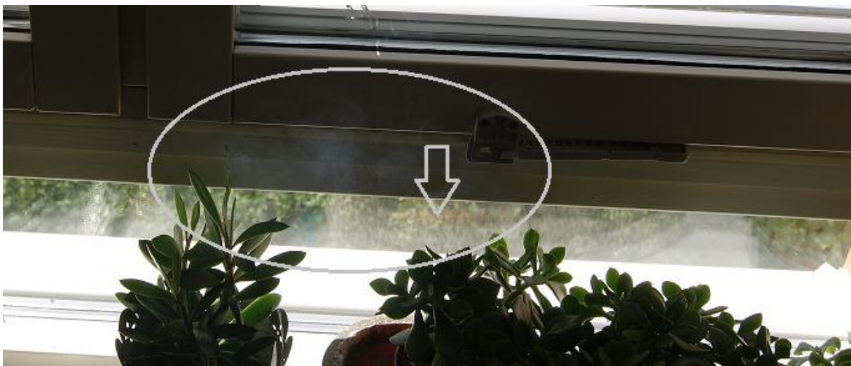
Figur 12. Bild från spårgasmätningen, röken rör sig tydligt ut i rummet.
