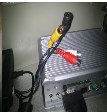
Figur 10. Datorenheten som loggar all data. Mätvärden kan ses live om den kopplas upp mot en datorskärm.
