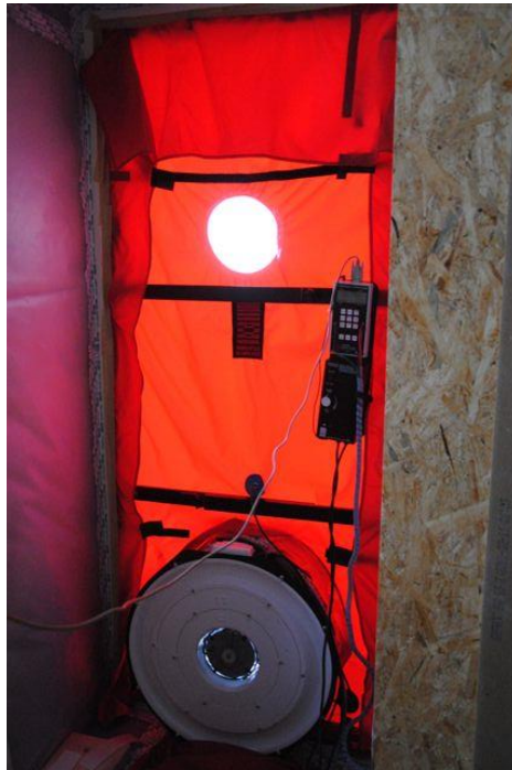
Figur 12. BlowerDoor fläkt med kontrollenhet monterad.
