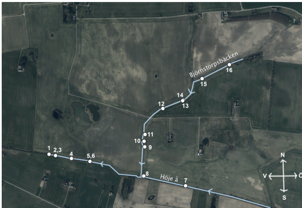
Figur 5.1. Placering av dräneringsledningarna som mynnar ut i Höje å och Björnstorpsbäcken, markerade som vita prickar. De blå linjerna indikerar sträckorna av vattendragen som undersökts. Bakgrundskarta © Lantmäteriet [I2014/00579]
