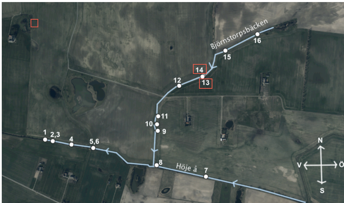
Figur 5.3. Placering av dräneringsledningar som mynnar ut i Höje å och Björnstorpsbäcken, markerade som vita prickar. De blå linjerna indikerar sträckorna av vattendragen som undersökts. Föreslagna åtgärder är en fosfordamm vid dräneringsledning 13, produktionsvåtmark vid dräneringsledning 14 samt en kalkfilterbädd intill dammen vid Lilla Åttarp (nordväst) som mottar dräneringsvatten. Bakgrundskarta © Lantmäteriet [I2014/00579]
