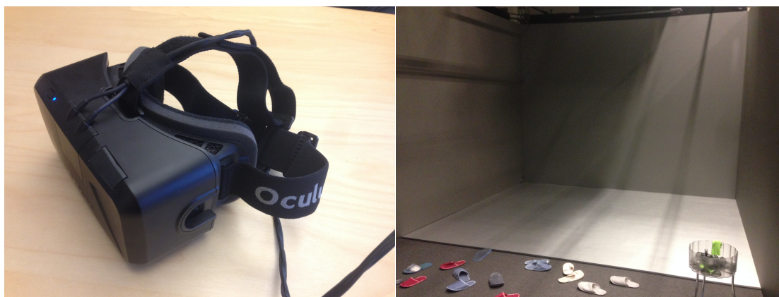
Figur 2.1. Head Mounted Display till vänster och ett CAVE-system till höger.
