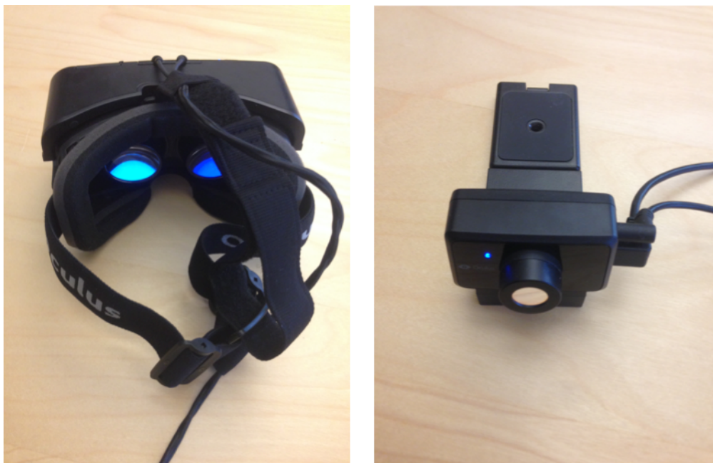
Figur 3.4 - Bilden till vänster visar en Head mounted display (Oculus Rift Development Kit 2). Den högra bilden visar den trackerutrustning som registrerar försökspersonens huvudrörelse.
