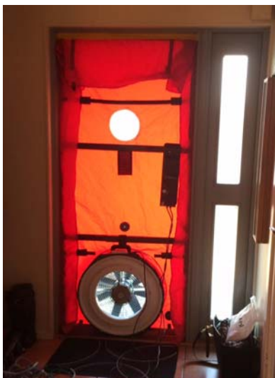
Figur 3.14 En Blowerdoor vid täthetsprovningen på Holländarehusvägen 5, Bjärred.
