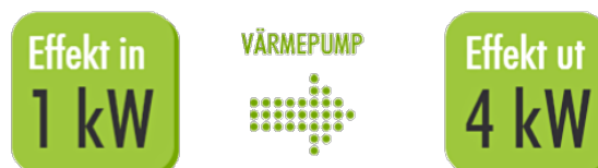
Figur 3.13 Innebörden av COP [26].
