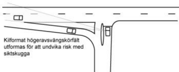
Figur 2.18 - Utformning för att undvika siktskugga (Trafikverket, 2012b)
