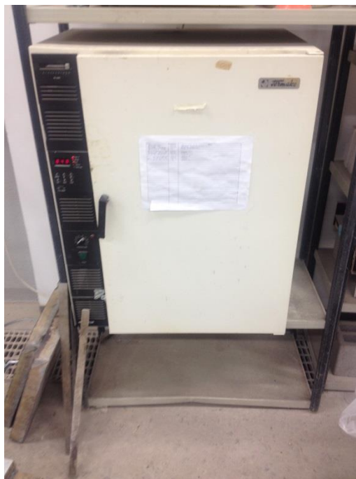
Figur 15 - Ugnen som användes för härdning av proverna.
