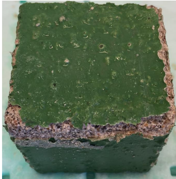
Figur 26 - Referensprov 5 målad med tätande färg och primer efter cykel 3.
