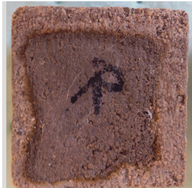
Figur 20 - Undersidan på ett referensprov efter en cykel. Skillnaden mellan skadad och oskadad betong.
