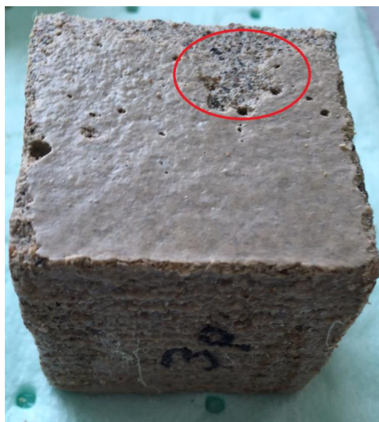
Figur 23 – Delvis avskalad yta på provkropp med 30 % slagg + penetron.
