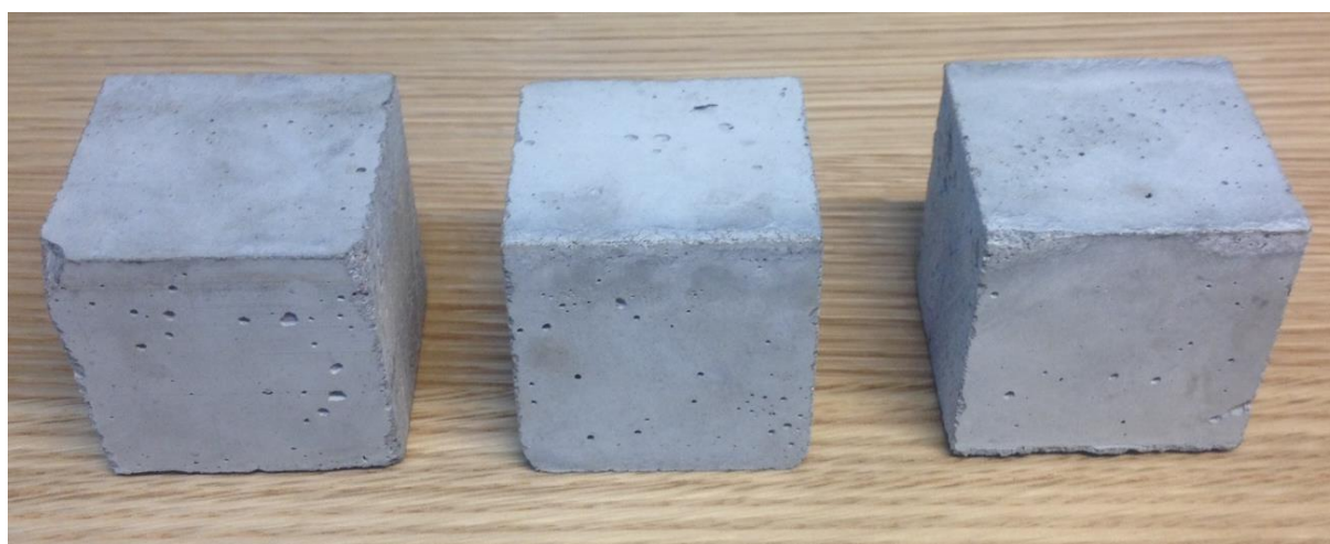
Figur 14 - Sågade provkroppar, kuber med sidan 5 cm.
