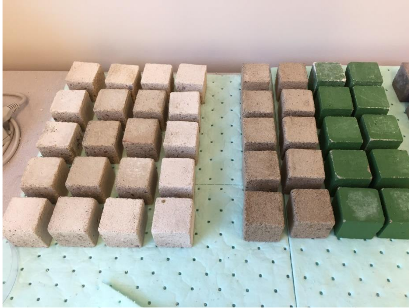
Figur 18 – Provkropparna som legat i svavelsyra torkar efter cykel 1
