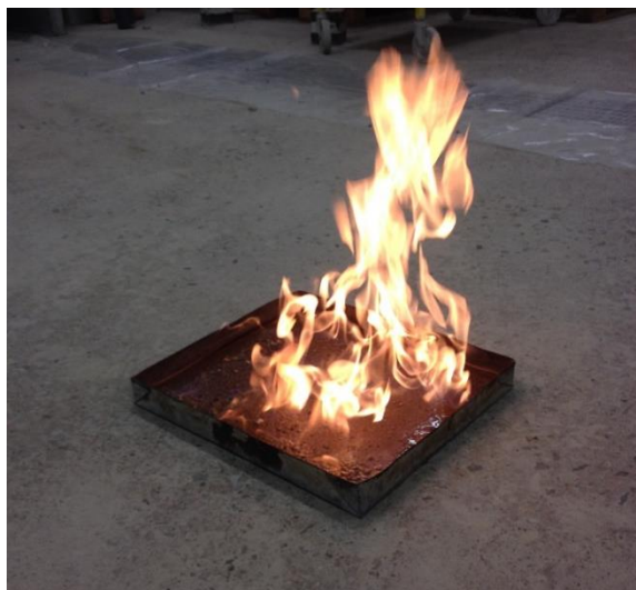
Figur 10 - Eldning av ballast (Henrik Sjöbeck)
