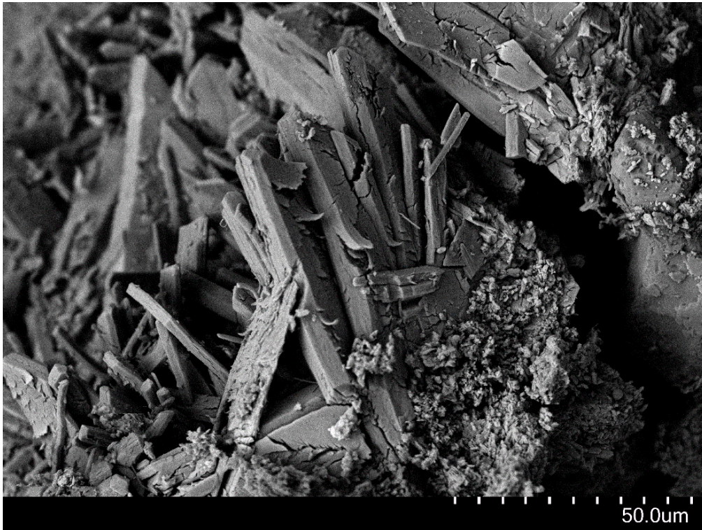
Figur 31 - Avlånga gipskristaller i ytan på ett svavelsyraangripet prov med 30 % slagg.
