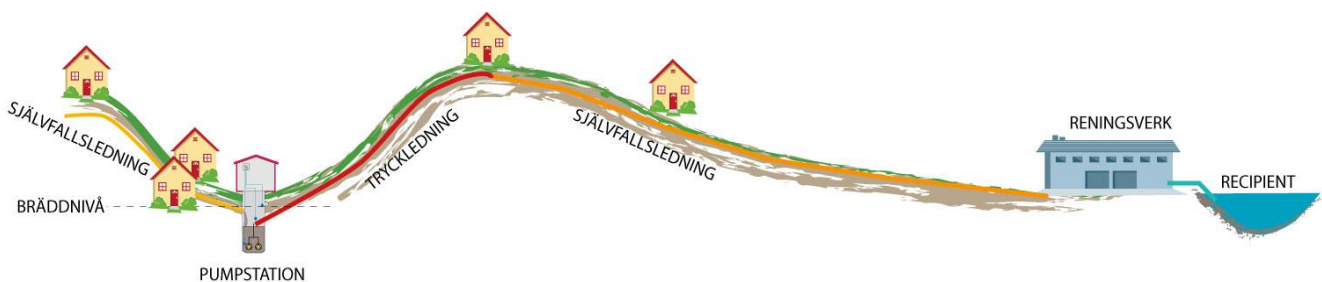
Figur 1 - Exempel på ledningssystem (Per-Åke Nilsson, Hässleholmsvatten)
