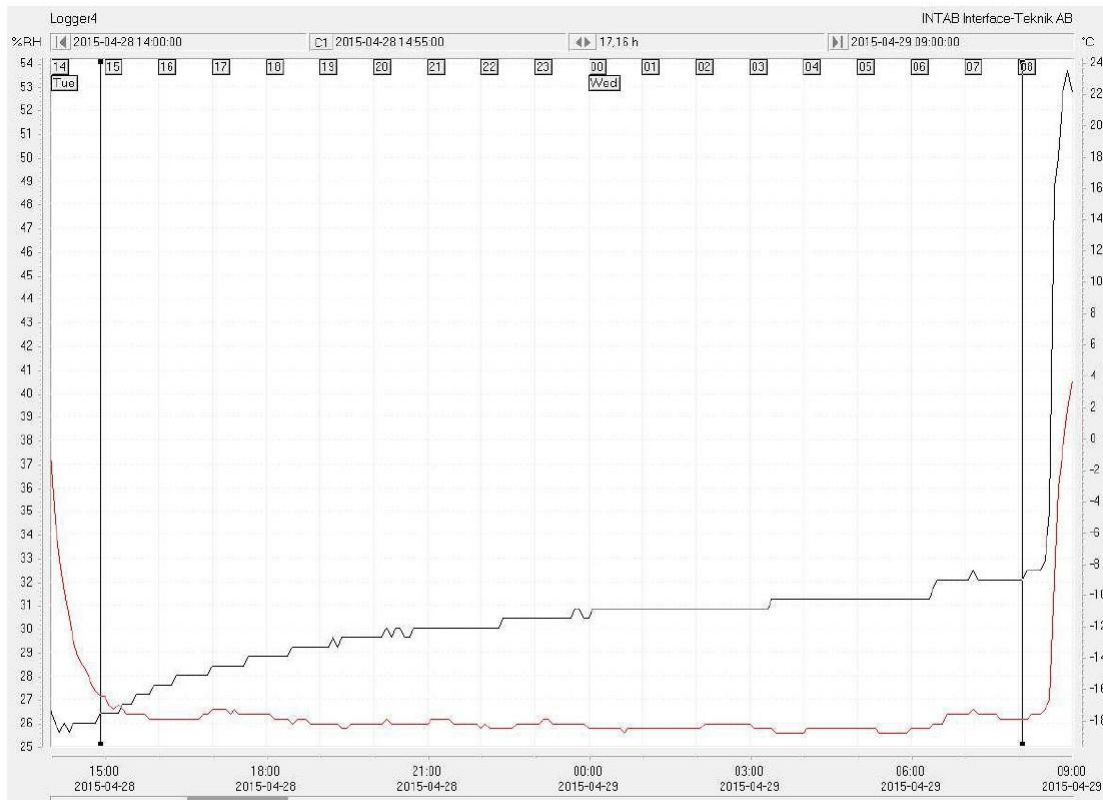
Diagram 2. Mätningar av sensor nr. 4. Röd kurva (nedre) - temperatur (°C); svart kurva (övre) - relativ luftfuktighet (% RH)
