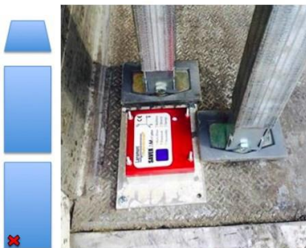
Bild 2. Placering av vibrations sensor i lastbil under transport 1 samt 2
