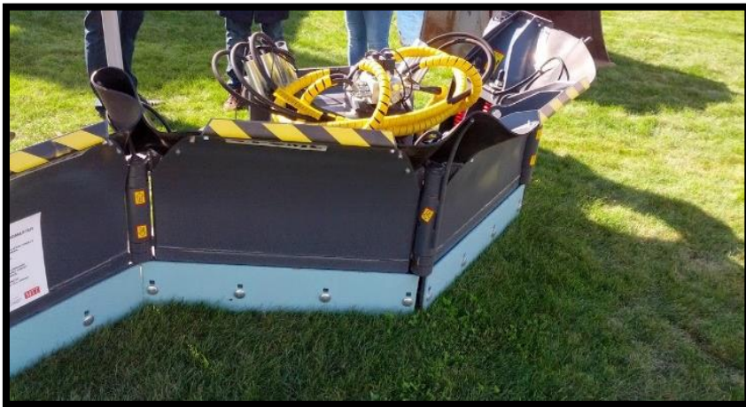
Figur 5.1 Flerledad frontplog med fjäderbelastat påkörningsskydd i nedkant.
