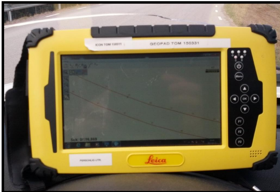
Figur 2.1 Leica iCON cc60/61 handdator som användes vid inmätning och körslingor.
