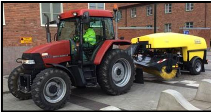
Figur 5.2 Sopsaltningsspridare efter traktor. Källa: Gatukontoret Malmö Stad
