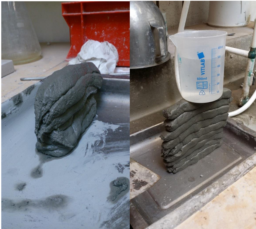
Figur 6 – Dålig byggbarhet (vänster) respektive bra byggbarhet (höger)
