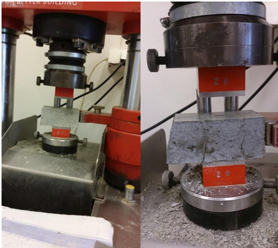
Figur 11 - Tryckbelastning för bestämning av tryckhållfasthet
