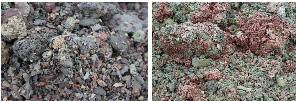
Figur 5 Fiberslammet som används i sluttäckningen på Lessebo deponi. I den vänstra bilden består materialet av mer lera. I den högra bilden ser materialet ut som små och blöta servettbitar. Foto: Tove Juhl Andersen
