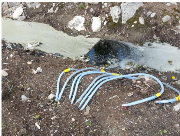
Figur 9 Slangarna som är kopplade till lysimetrarna. Slangarna ligger längst ner för slänten vid lakvattendiket. Foto: Tove Juhl Andersen
