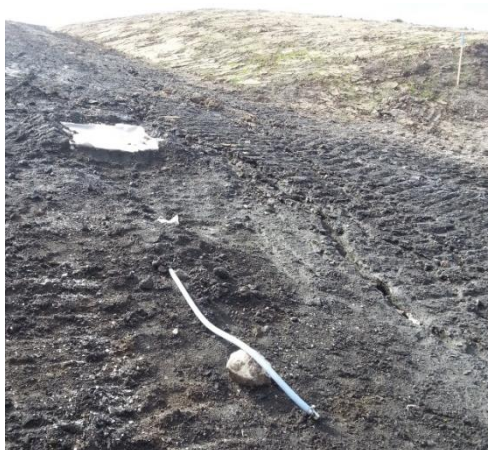
Figur 11 Lysimeter Norr 0 placerad utanför pilotsluttäckningen. Foto: Tove Juhl Andersen
