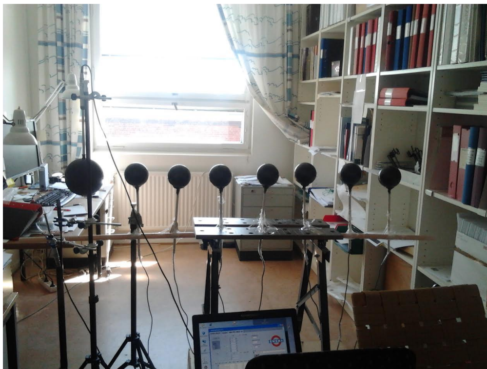
Figur 2.5 Bilden visar de åtta globtermometrarna är placerade centralt i ett kontorsrum framför ett fönster mot öster under februari månad.
