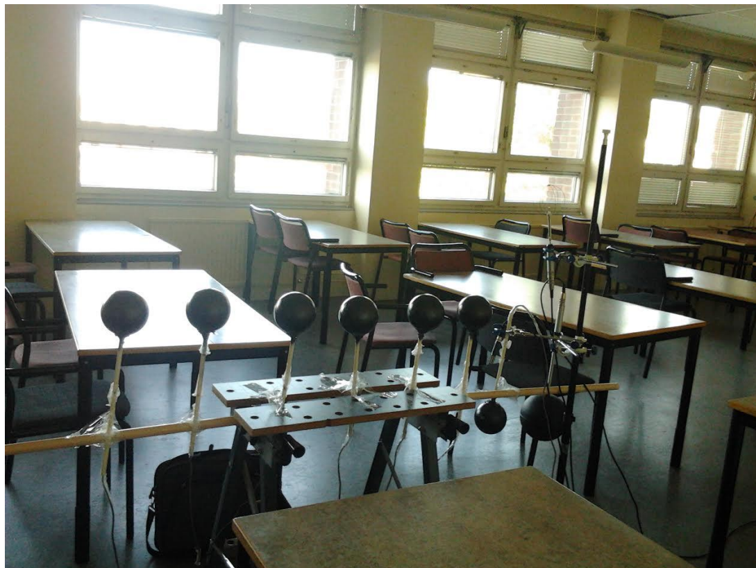
Figur 2.23 Bilden visar de åtta globtermometrarna är placerade centralt i klassrummet V:C framför ett fönster under maj månad.
