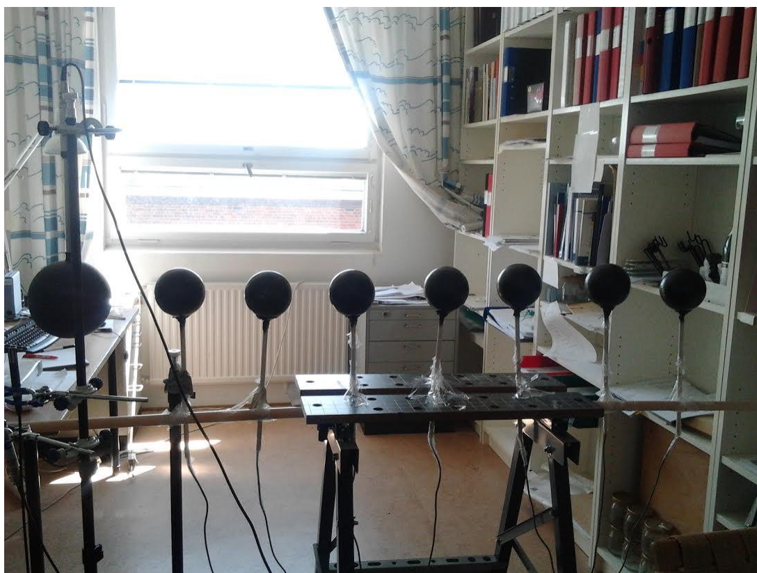
Figur 2.14 Bilden visar de åtta globtermometrarna är placerade centralt i ett kontorsrum framför ett fönster mot öster under maj månad.
