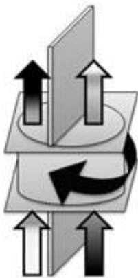
Figur 9 -Schematisk bild över roterande värmväxlarens luftflöden
