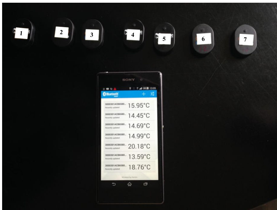
Figur 3 Sensorer märkta med respektive nummer (S1–7), samt mobiltelefon med programvara som registrerar information om temperatur.
