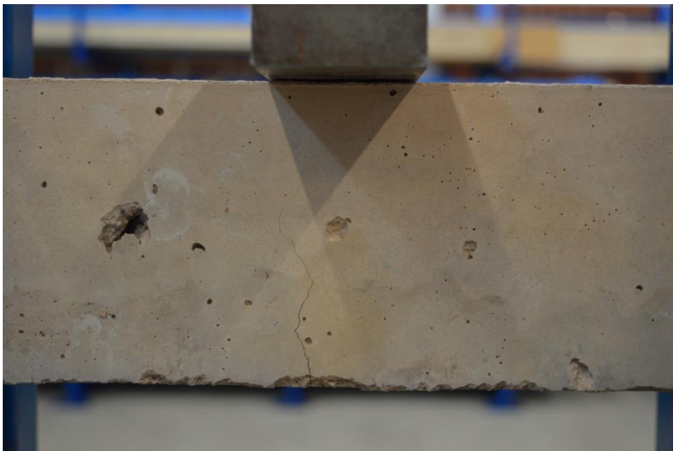
Figur 21. Den första böjsprickan uppstår som en följd till att böjdragheten har uppnåtts i nederkant. Detta markerar att balken har övergått från stadium I till stadium II. Detta markeras av område 2 i last-nedböjnings sambandet.
