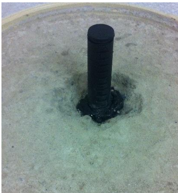
Figur 40. Krater som bildats vid borrning i betongen ca 5 dygn efter härdning. Foto: Abdel Ali.
