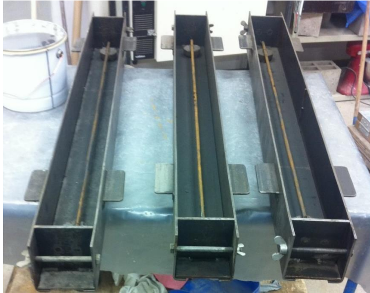
Figur 13. Balkformarna som användes innehållande armering.
