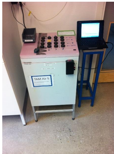
Figur 12. TAM-air med en dator som loggar värmeeffekten.
