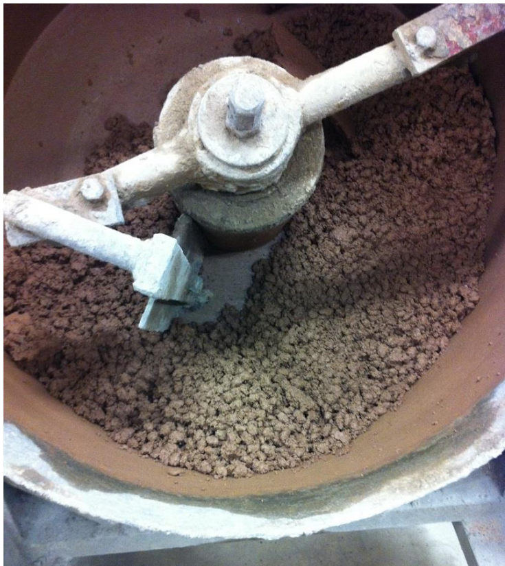
Figur 32. Betongmassan innan tillsats av flyttillsatsmedel.
