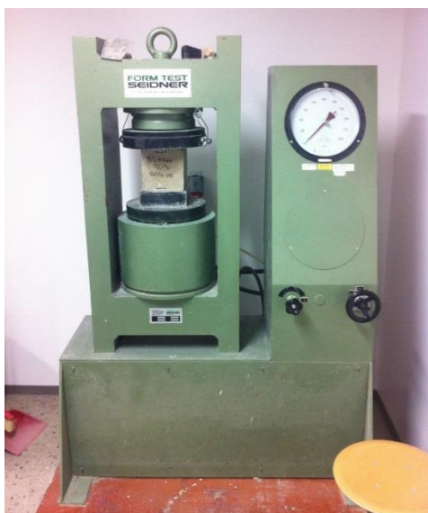
Figur 17. Maskinen som användes vid tryckhållfasthetstesterna.
