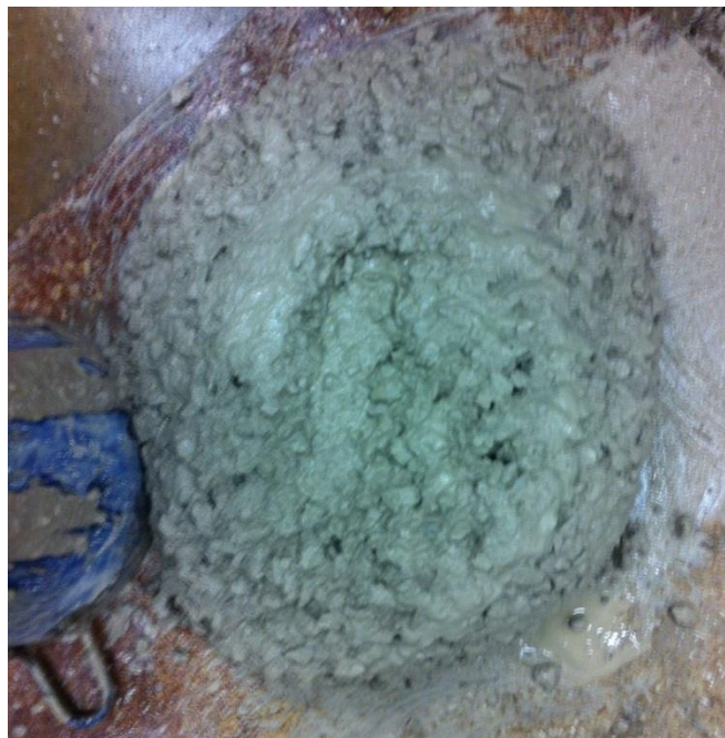
Figur 31. Efter sättmått är betongen fortfarande homogen.
