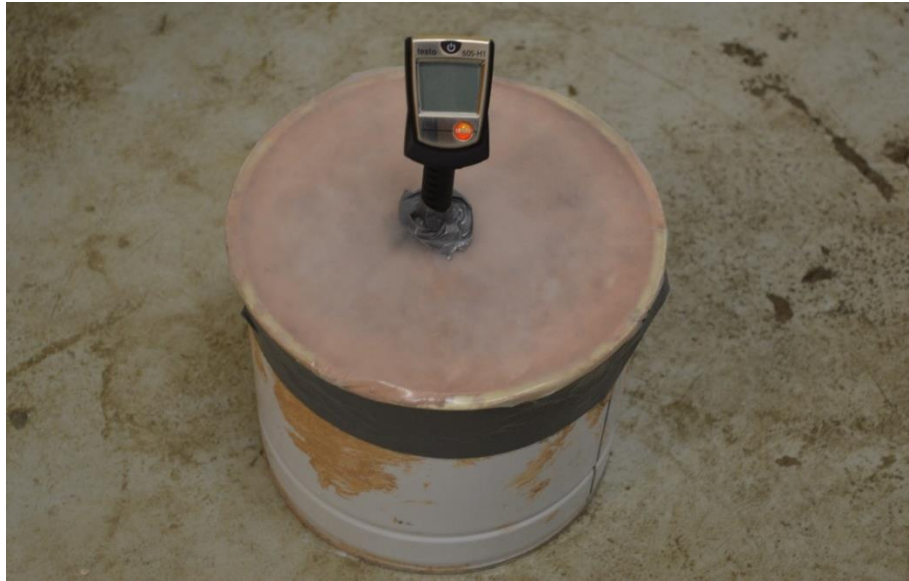
Figur 18. Hink som är fylld till toppen med betong och tätad med plast.
