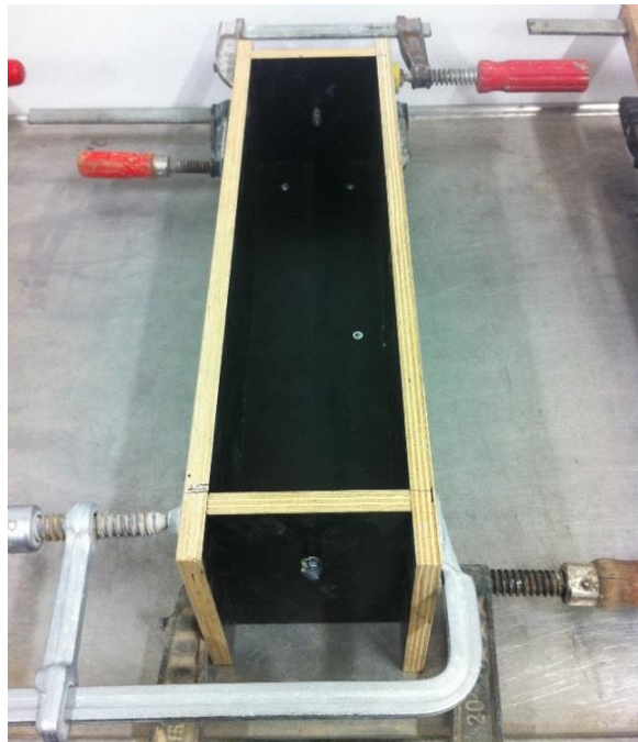
Figur 14. En av formarna för provkropparna vars krympning ska mätas.
