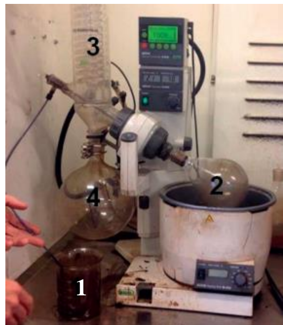
Figur 3.3 – Avskiljare för bitumen och lösningsmedel (Andersson & Sulejmani, 2014).
