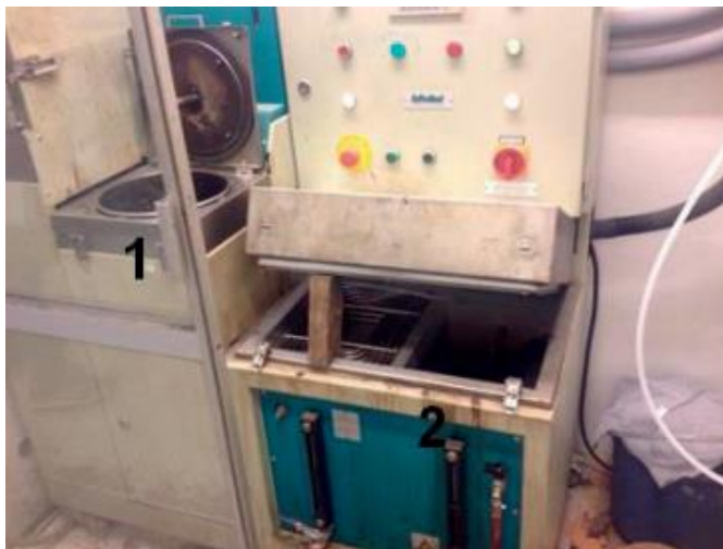
Figur 3.2 – Centrifug vid punkt 1 och tappstation av bitumen och lösningsmedlet vid punkt 2 (Andersson & Sulejmani, 2014).
