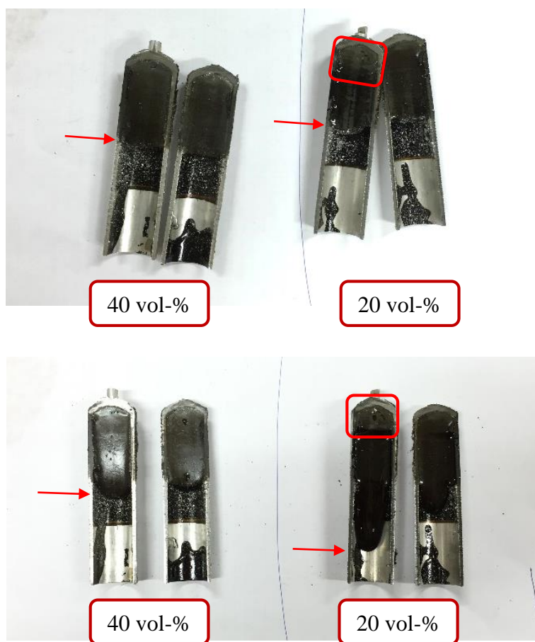
Figur 5.1 – RVB-rör delade på mitten. Överst direkt efteråt och nedan efter två veckor. I 20 vol-% röret syns en tydlig sedimentation (markeringen) och bruket flyter ut väsentligt mer än 40 vol-% vilket delvis beror på sedimentationen.
