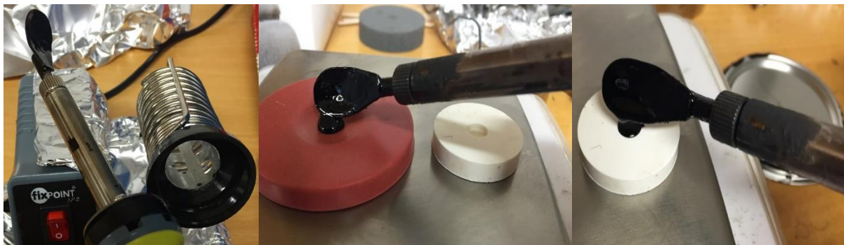
Figur 3.7 – Från vänster; Lödkolv med skopa, gjutning med provkropp i 25 mm form, gjutning av provkropp i 8 mm form.
