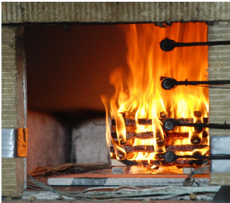
Figur 3.8: Vid försök med liten öppning bildades ett tydligt brandgaslager. Vid försök med stora öppningar var gränsskiktet mindre skarpt.
