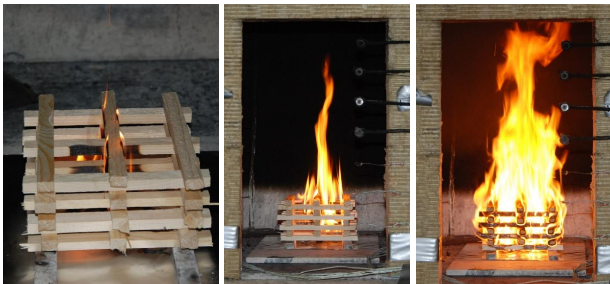
Figur 3.6: Bilder över brandförloppet från ett försök med den snabba bränslekonfigurationen.
