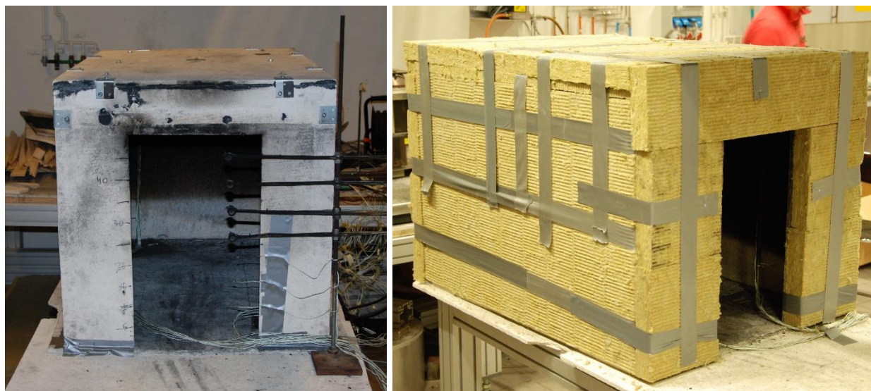
Figur 3.2: Det nedskalade modellrummet som användes vid försöken, till vänster utan isolering och till höger med isolering.
