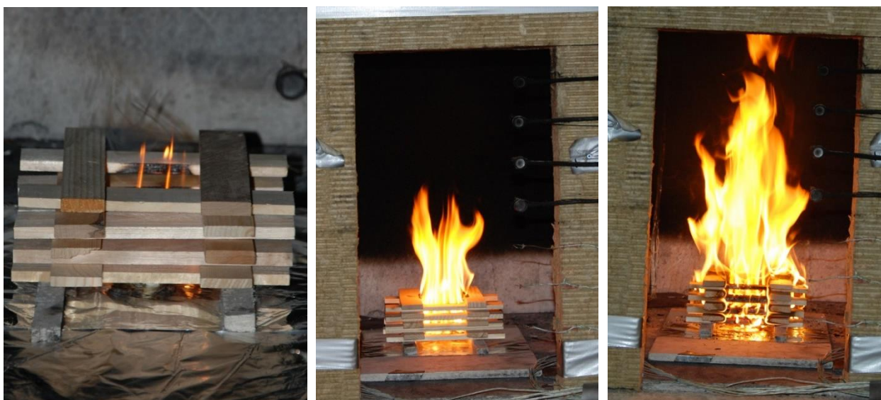
Figur 3.7: Bilder över brandförloppet från ett försök med den långsamma bränslekonfigurationen.
