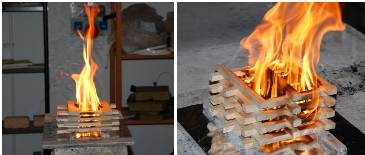
Figur 3.5: De två olika bränslekonfigurationerna en stund efter antändning.
