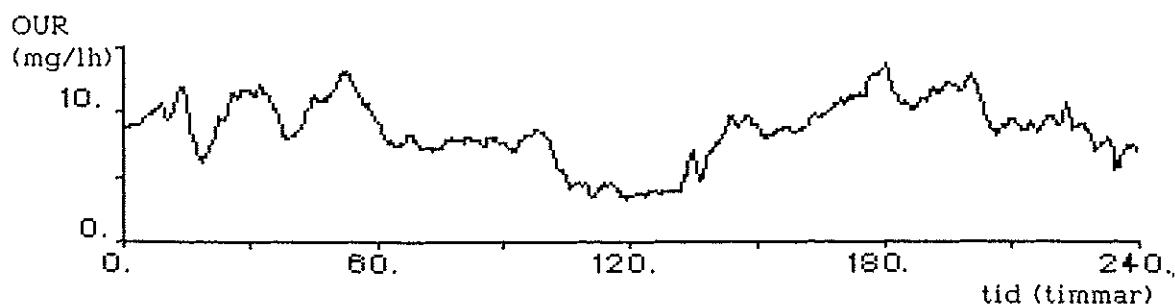
Figur 5.3 Beräkning av syreupptagningsförmågan OUR. Om man jämför med syrekoncentrationen ser man att OUR varierar på motsatt sätt.
