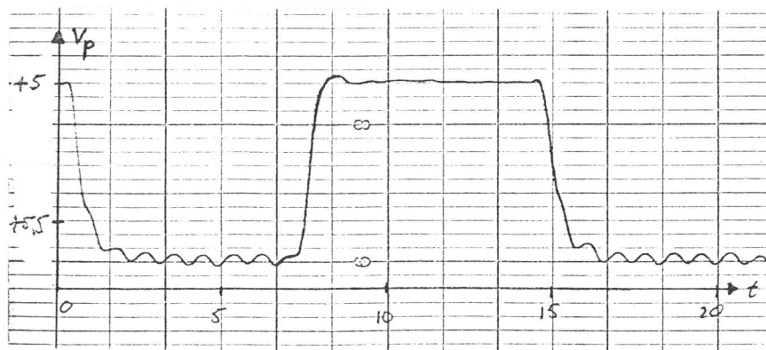
Fig.26 Hastighetssignalen vid reglering av enbart bandspänningen
