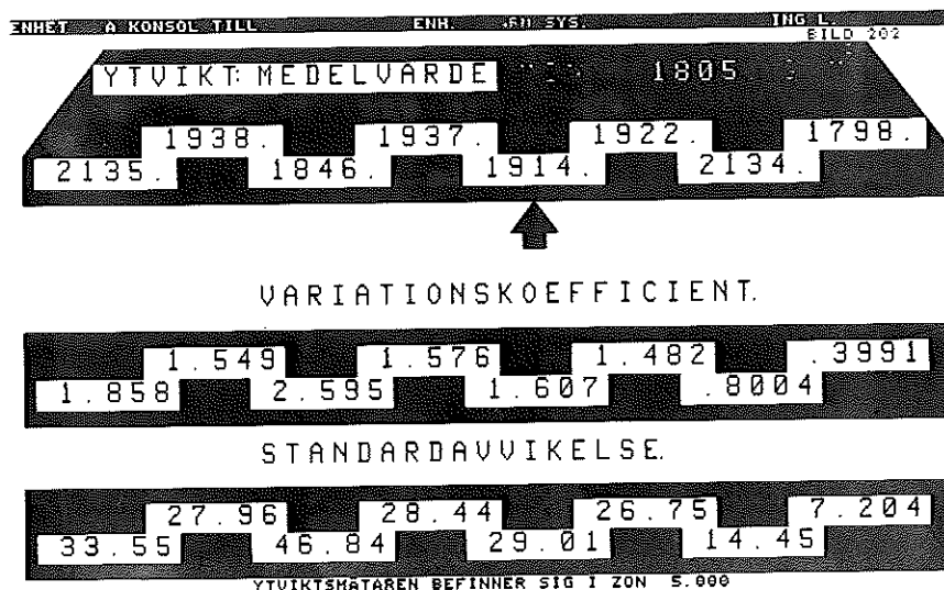
Fig 4.48 Bild för att visa aktuella parametrar på bildskärm. Ytviktsmätaren finns i zon 5 och har givit m = 1914 \text{ g/m}^2 , s = 29.01 \text{ g/m}^2 samt R = 1.607 vid senaste uppdateringen.
