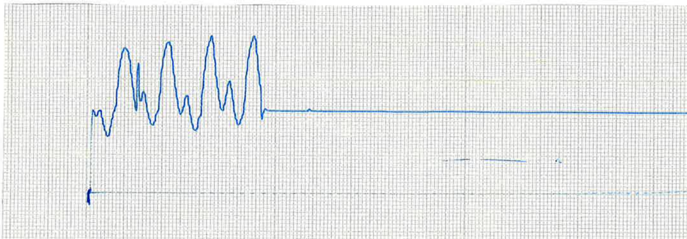
Fig 15. Plottning av integratorns insignal. Frekvens 40 kHz
