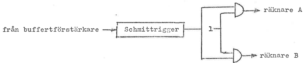
Figur 4.38 Beslutskretsens utformning. Schmittriggern anpassar signalnivån till OCH - grindarna.
